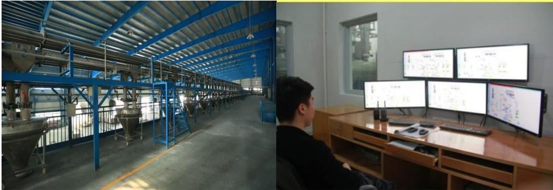
图 15 公司智能全封闭式粉料集中输配系统
